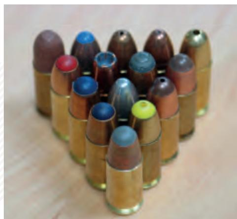
Das Bild vermittelt einen Eindruck von der Vielzahl an Geschossogivenformen, -konstruktionen und -materialien. Funktional stellt dies bzgl. der Patronenzuführung und des Verschlussantriebs maximale Herausforderungen an die Waffenplattform.
